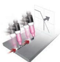
Consente l'immediato spegnimento dell'arco durante la rampa di discesa o la ripartenza del ciclo di saldatura.
