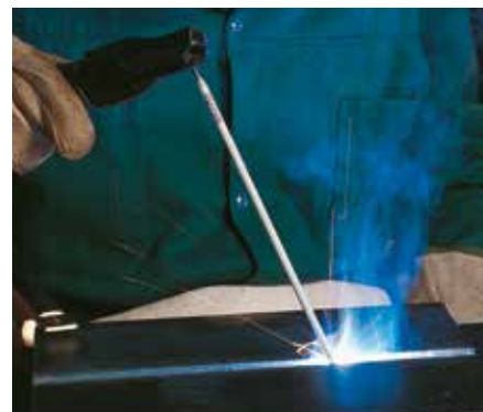
MMA en una unión en V
