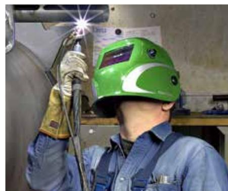
La Focus TIG 160 DC HP se suministra con electrodos de tungsteno MIGA Super Blue, que tienen excelentes propiedades de encendido y reencendido, y son aplicables para todo tipo de materiales.
