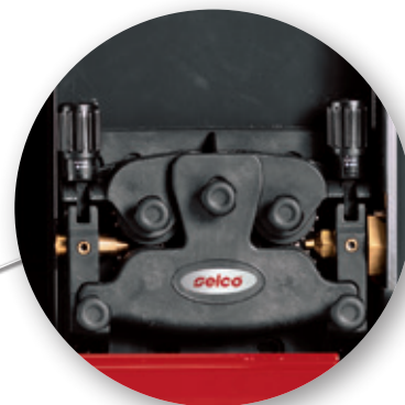
Actionnement à quatre galets Cuatro rodillos de accionamiento Vier-rollen aandrijving
