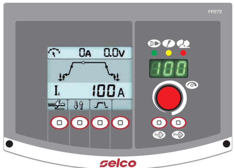
Le panneau de contrôle permet de personnaliser à volonté la caractéristique du soudage TIG, grâce aux innombrables possibilités de réglage des paramètres de travail. En entrant dans le mode Set Up, on peut définir les temps de pré- et post-gaz, les courants initial et final, le courant de Bi-level, les temps des rampes de montée et de descente, la fréquence du mode fastpulse et bien d'autres fonctions encore.
