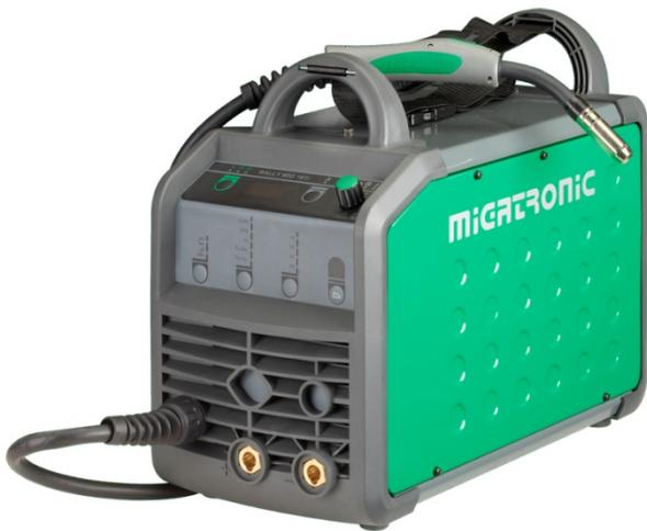
RallyMIG 161i es una soldadora multifuncional compacta y portátil, lo cual significa que tiene todos los procesos al alcance de la mano: MIG, MMA y TIG simple. En cualquier momento y lugar. La soldadora es monofásica (230 V) y está equipada con PFC (Corrección del Factor de Potencia) para permitirle soldar con un cable de alimentación largo o un generador como fuente de energía.
